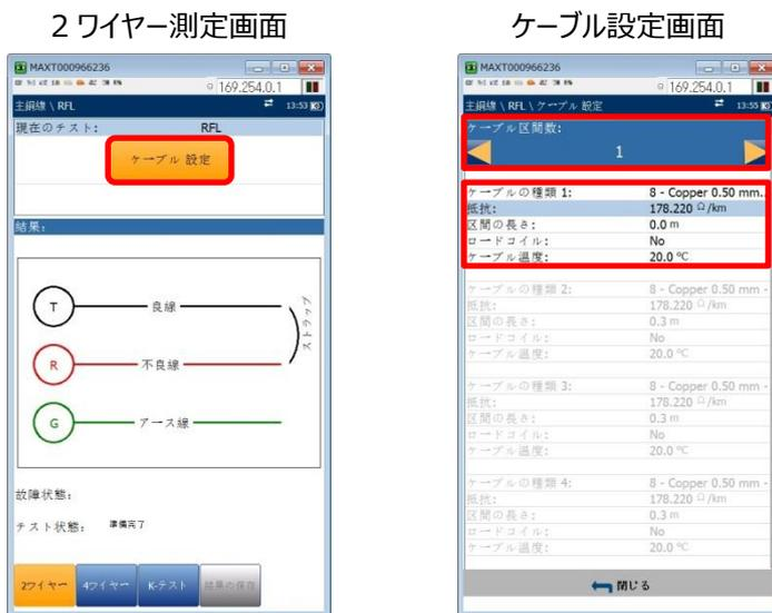
(4) 良線/不良線/アース線を図通りに接続して、『Start/Stop』ボタンを押して測定を開始します。障害点が測定できた場合は、障害点までの距離が表示されます。障害点が測定できない、遠端側でループされていないなどの場合には、故障状態の欄にエラーメッセージが表示されます。
