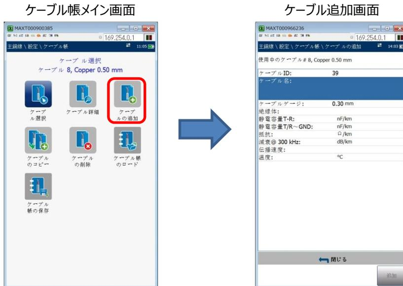
(2) 下矢印キーで各パラメータに移動して決定キーで設定します。ケーブル ID については、自動で割り振られます。また、追加したケーブルタイプは、ケーブル帳の「CableBookSettings」に追加されます。
