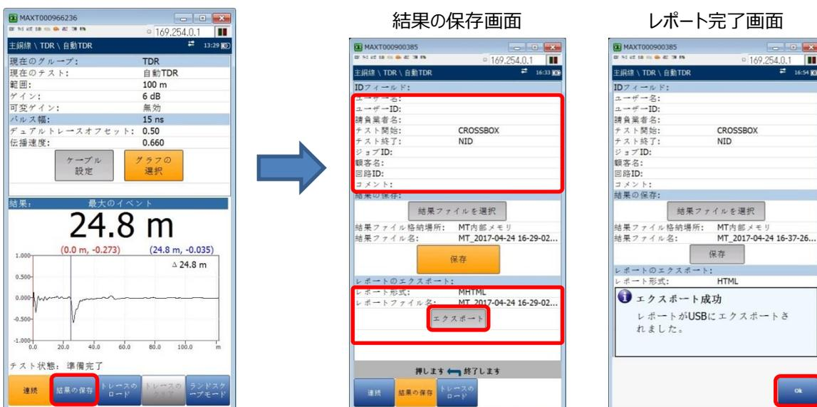
(8) 測定結果は、以前に測定した結果と比較(トレース)することができます。但し、過去の測定データを保存しておく必要があります。測定終了後、または測定中に画面下の『**トレースのロード**』を選択します。
