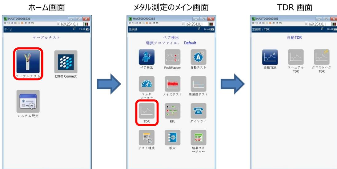
TDR(パルス試験)測定方法には、3種類の測定方法が存在します。測定状況に応じて、選択してください。
