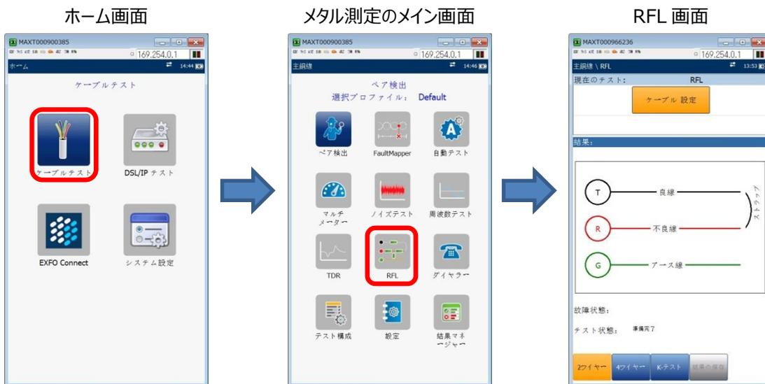
(2) 画面下で 3 種類の測定方法から選択します。図と同じように回路を組みます。
