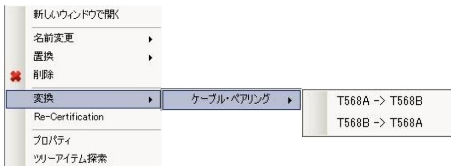
(6) Re-Certification をクリックします。選択したテスト結果に対して再度、他のテスト規格で認証試験を適用することができます。但し、テスト構成が合わない場合は、失敗します。(エラーメッセージが表示されます。)
