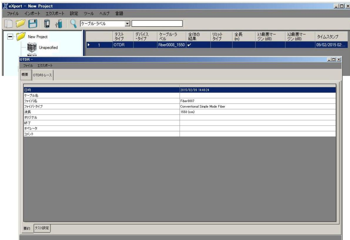
(3) マウスのカーソルを“OTDR トレース”の詳細ビューのチャートに動かし、絶対値の結果に対する距離を閲覧します。
