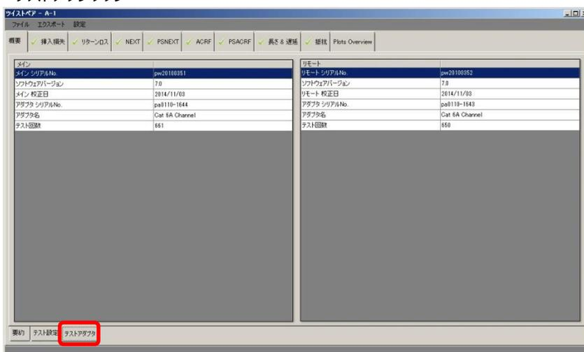
(3) 各項目のタブをクリックすると、プロット、最悪マージンや他の詳細情報が表示されます。プロット上でマウスのスクロールを使うと、テスト結果のズームイン・アウトが出来、右クリックでプロットのオプション情報が閲覧できます。
