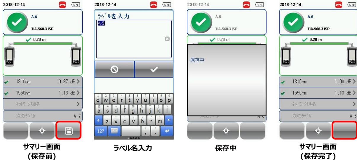
※ 自動保存設定(**SETUP** → **プロジェクト設定** → **自動保存**)とラベル名の設定(**SETUP** → **プロジェクト設定** → **ラベル名の候補**)がされている場合は、オートテスト完了後、テスト結果が合格時のみ自動的に結果が保存されます。(テスト結果が不合格の場合は、手動で保存できます。)
