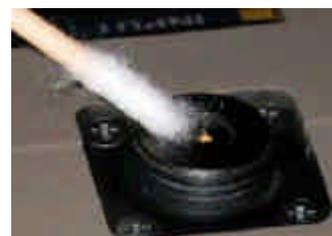
99%以上のエタノール等をセンサ面に数滴たらし、極細綿棒でセンサ面の汚れを優しくこすり取ってください。このとき拡大鏡や顕微鏡を使うことを、お奨めします。
