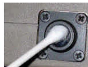
2本の綿棒の先端を互いにすり合わせてもみほぐしてから使うと効果的です。綿棒は糸くずの出にくい種類のものを使ってください。一度使った綿棒は再使用せずに捨ててください。
