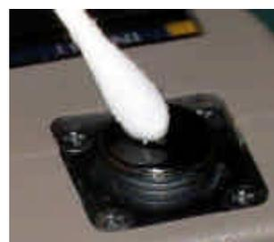
綿棒は糸くずの出にくい種類のものを使ってください。一度使った綿棒は再使用せずに捨ててください。
