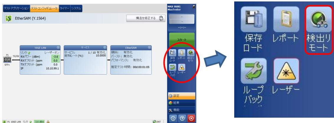
3. リモート検索画面で【スキャン】をクリックします。リモートと正常に接続されている場合は、リモート側の IP アドレスが表示されます。リモート側の IP アドレスを選択して、【ループアップ】をクリックします。
