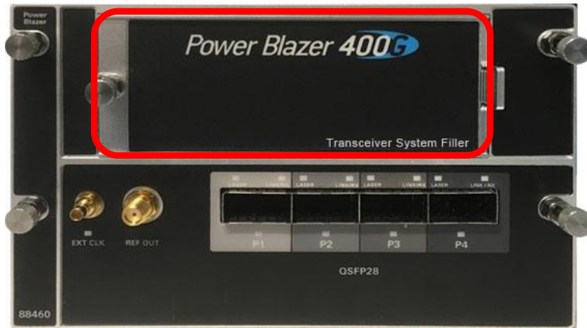
トランシーバシステムポート
