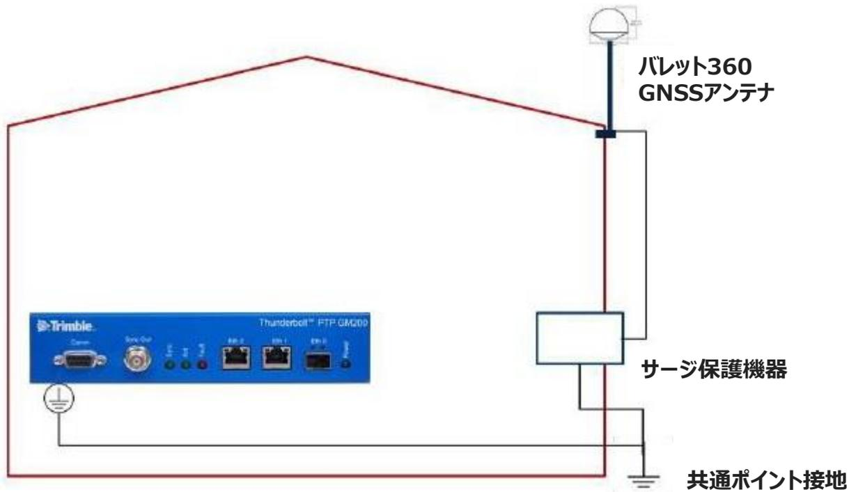
最低6AWG (13.3mm) 以上のケーブルの使用を推奨します。
