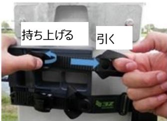
リリースラッチを持ち上げてループを引っ張り、ストラップクランプを外します。
