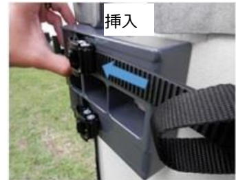
ラチェットバックルにラバーストラップを差し込みます。
