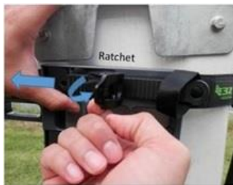
ウェビングがアンテナにきつくなるまで、ラダーストラップをバックルに通してラチェットします。
