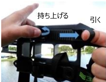
ラバーストラップをラチェットバックルから外します。
