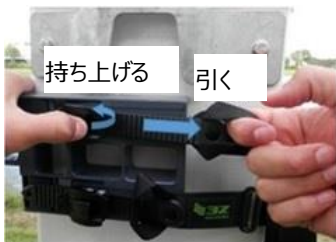
リリースラッチを持ち上げてループを引っ張り、ストラップクランプを外します。
