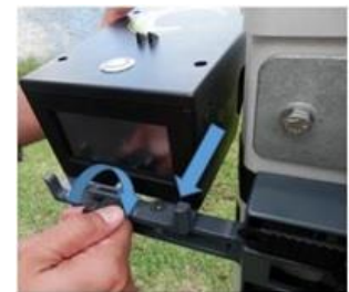
ストラップクランプを固定したら、RF アンテナを取り付けて位置合わせを行います。設定完了後、RF をアンテナから取り外す。
