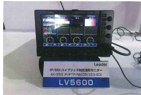
写真4 IP信号対応波形モニタLV5600
