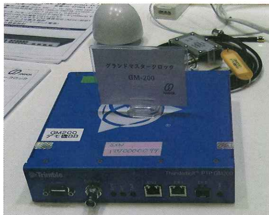
写真6 原田産業の高性能グランドマスター IPパビリオンに参加していた原田産業が取り扱っている米国Protempis(プロテンピス)社製のグランドマスターGM200。ハーフラックサイズで小型に作られている。
