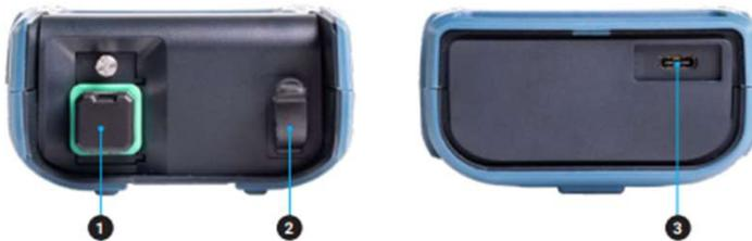
①各ポート (OTDR/光源パワーメータースワップアウトコネクタ)
